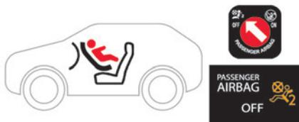
! Der Beifahrer-Front-Airbag muss deaktiviert werden, bevor ein Kindersitz entgegen der Fahrtrichtung eingebaut wird. Andernfalls **könnte das Kind beim Entfalten des Airbags schwere oder sogar tödliche Verletzungen erleiden.**
