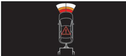
**i** Die Einparkhilfe hinten wird bei Montage eines Anhängers oder eines Fahrradträgers auf der Anhängerkupplung (bei Fahrzeugen mit nach Herstellervorgaben montierter Anhängerkupplung) automatisch deaktiviert. In diesem Fall wird der Umriss eines Anhängers hinter dem Bild des Fahrzeugs angezeigt.
