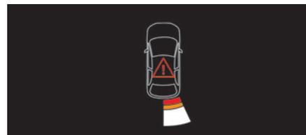
Diese ergänzt das akustische Signal durch Anzeige von Balken auf dem Bildschirm, die den Abstand zwischen dem Hindernis und dem Fahrzeug darstellen (weiß: in größerer Entfernung, orange: in der Nähe, rot: in unmittelbarer Nähe).
