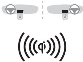
Mit diesem System können tragbare Geräte wie Smartphones kabellos geladen werden, indem das Prinzip der magnetischen Induktion gemäß der Norm Qi genutzt wird.
