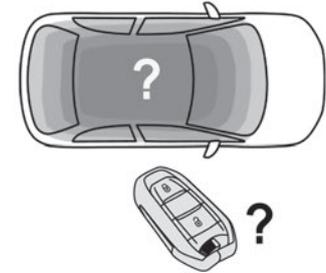
Wenn der elektronische Schlüssel nicht erkannt wird oder sich nicht mehr im Erkennungsbereich befindet, erscheint beim Schließen einer Tür oder bei dem Versuch, den Motor abzustellen, eine Meldung auf dem Kombiinstrument.
