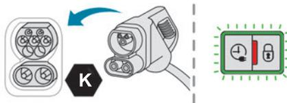
► Je nach Ausführung, entfernen Sie die Schutzabdeckung vom unteren Teil des Anschlusses.
