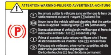
Stellen Sie vor Verlassen des Fahrzeugs sicher, dass die Feststellbremse angezogen ist: Die Kontrollleuchten für die Feststellbremse
