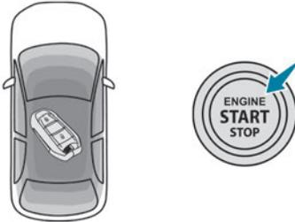
Mit dem elektronischen Schlüssel im Fahrzeuginnenraum kann durch Drücken der Taste „**START/STOP**“ und **ohne Betätigung der Pedale** die Zündung eingeschaltet werden, ohne den Motor zu starten.
